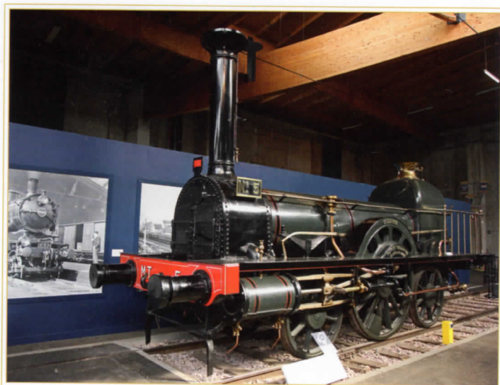
La Sézanne à la Cité du Train Locomotive à vapeur type 111 N°5 construite par Alfred Halatte, à chauffe à combustible liquide. Crédit photo : Jean-Jacques d'Angelo
